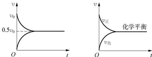
(a) 汽车以恒定功率启动和运行过程中突然以减半的恒定功率运动的速度—时间图象
