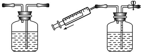
图5 气体收集装置 图6 气密性检查
