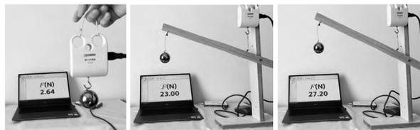
图2 模拟“手臂提物”的实验装置
