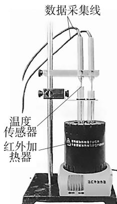
图 9 使用 DIS 温度传感器开展晶体熔化和凝固实验
