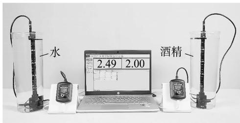
图1 不同密度液体内部压强与深度关系实验装置图
